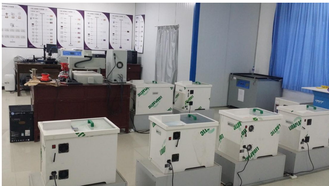
图 7-6 新建的 PCB 工程实训室，可以完成 6mil 精度的 PCB 线路板制作
