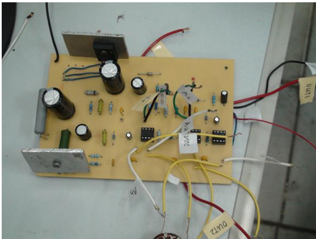
图 7-1 学生电子电路分析制作与调试课程模拟电子技术部分实习作品——双路输出的直流稳压电源。
