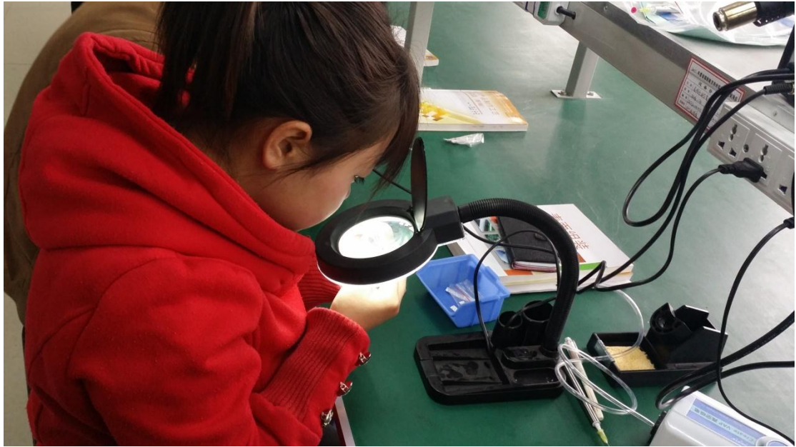
图 7-4 SMT 表面组装技术课程学生检查电路焊接质量。
